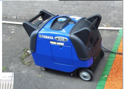
昨年度、札幌市の予算補助で導入した発電機。発電能力は2,800W。不十分ながら既存の1台と合わせて2台を確保。
